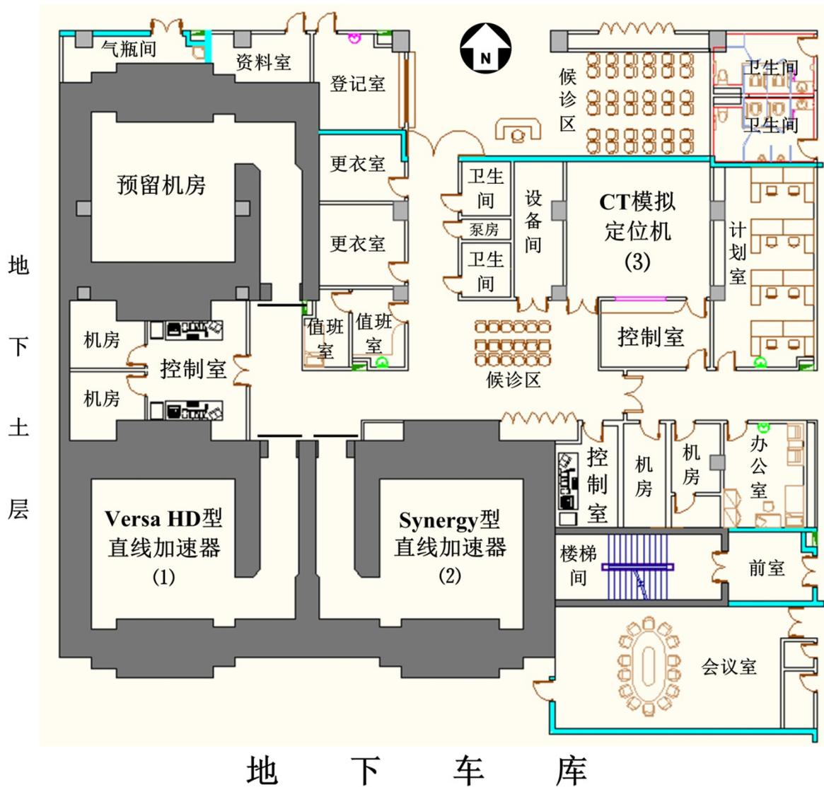
图 3-3 地下二层加速器机房平面布局及周围环境示意图
